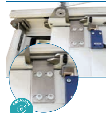
VERROUILLAGE MÉCANIQUE DU PORTILLON DÈS QUE LA PORTE DE GARAGE S'OUVRE
